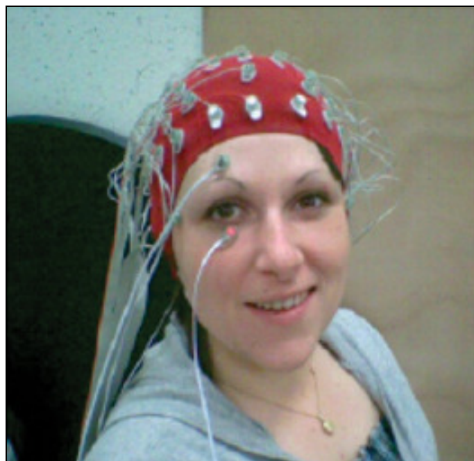
Figure 6. Casque à 64 électrodes pour l'EEG. Le clignement des yeux est mesuré par deux électrodes complémentaires, car l'activité musculaire du visage peut parasiter l'enregistrement.
